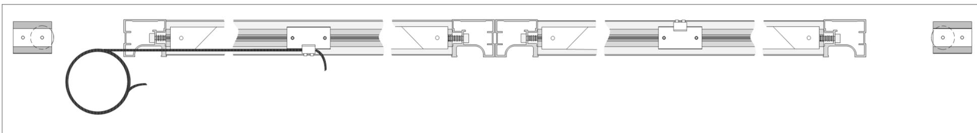
3. Свободный конец троса пропустите через ближайший ролик и протяните трос до следующей закладной синхронного механизма. .
