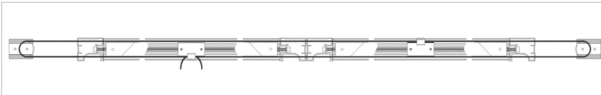
8. Произведите окончательную натяжку троса, следите чтобы трос не соскочил с роликов. Достаточным натяжением считается такое состояние тросика при котором он не провисает и не цепляется за элементы конструкции.
